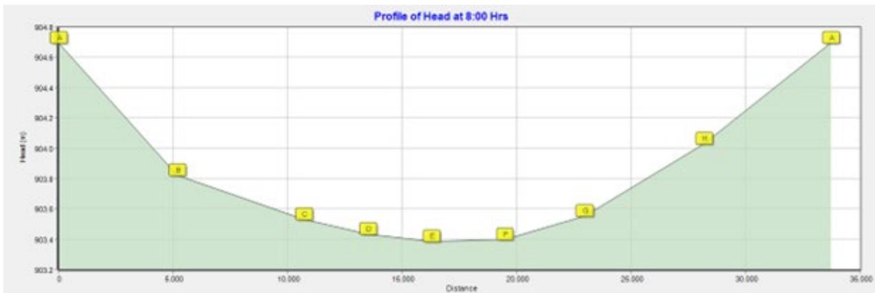
Figura 12: Linea piezometrica in condizioni di punta dell'anello esterno – EPANET.
