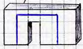
approssimazione secondo normativa di un elemento in muratura.
