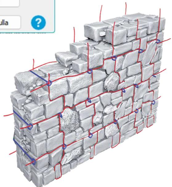
L'iniezione di nuova malta nelle murature viene condotta attraverso l'accoppiamento di un miscelatore ed un compressore, praticando una maglia di fori nella parete attraverso cui iniettare una boiaccia di calce (compatibile con la muratura esistente), ponendo particolare attenzione alla pulizia dei fori (da condursi con acqua) per limitare l'assorbimento nella muratura dell'acqua di impasto. L'intervento è dunque compatibile, non reversibile e non distinguibile.
