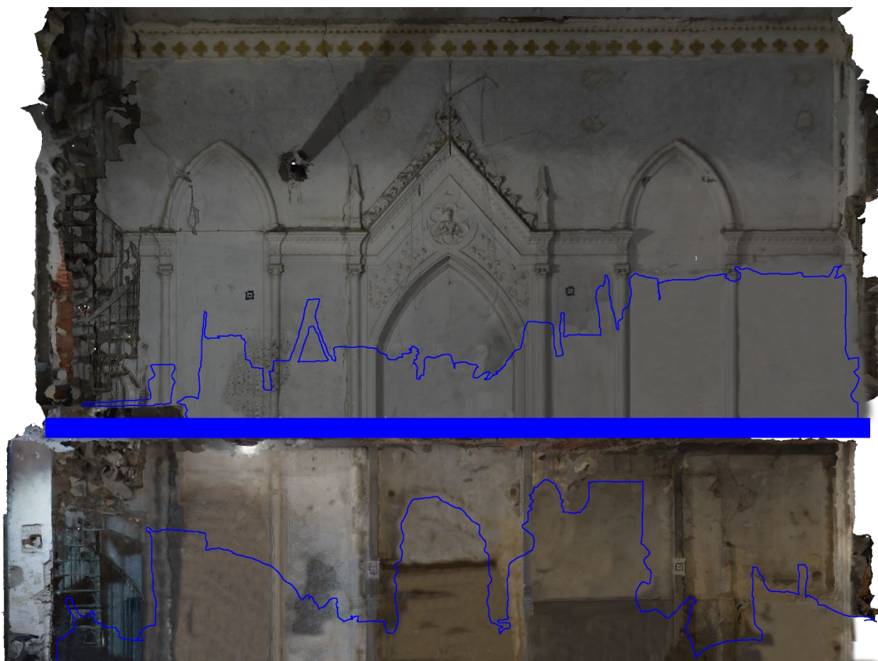
Figura 39: Ricostruzione del fronte tramite ortofoto (29 febbraio 2024). Le integrazioni sono state evidenziate con un contorno in blu (28 maggio 2024).
