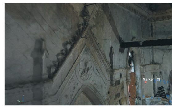
Modello mesh degli interni della chiesa con indicazione dei target fotogrammetrici.
