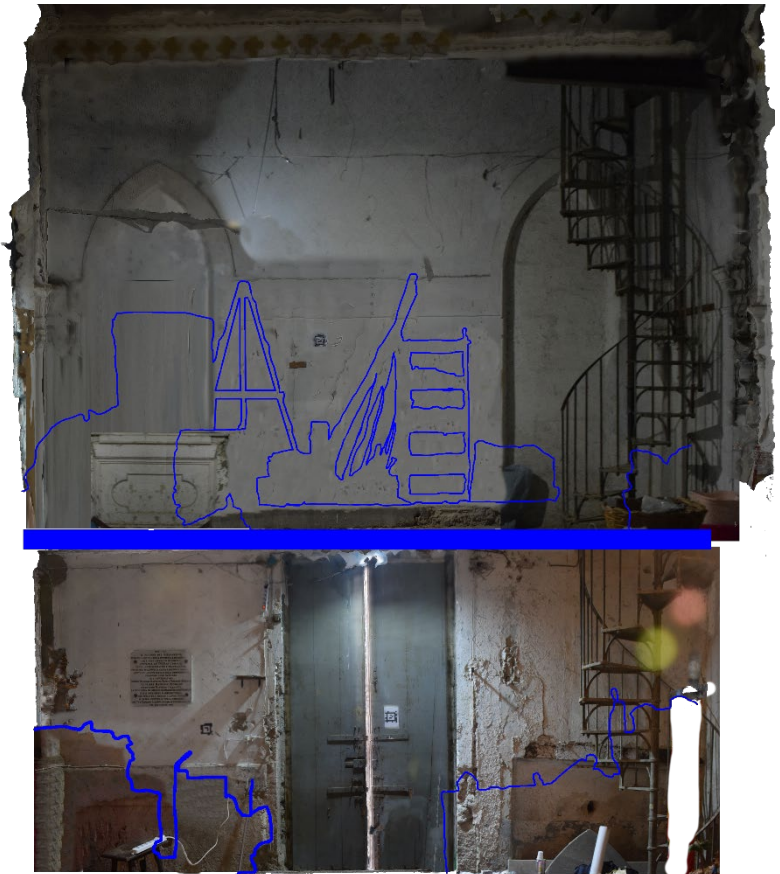
Figura 42: Ricostruzione del fronte tramite ortofoto (29 febbraio 2024). Le integrazioni sono state evidenziate con un contorno in blu (29 maggio 2024).
